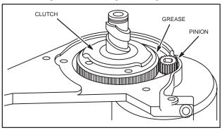
Fig. 660 - LUBRICATING GEARS
