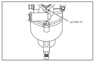
Fig. 277 - FLANGE MARKING, FUEL PUMP
