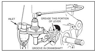
Fig. 305 - INSTALLING FUEL PUMP
