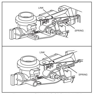
Fig. 203 - INSTALLING GROUND WIRE
