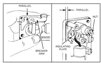
Fig. 46 - ADJUSTING BREAKER BOX
