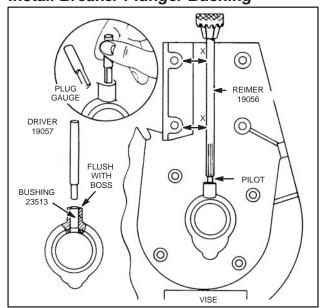
Fig. 37 – INSTALLING BREAKER PLUNGER BUSHING
