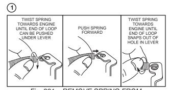
Fig. 331 – REMOVE SPRING FROM CONTROL LEVER
