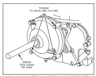
Fig. 142 - INSTALLING GEAR CASE COVER
