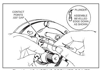
Fig. 16 - ADJUSTING BREAKER POINTS
