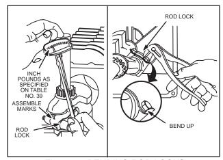
Fig. 555 - BENDING ROD LOCKS
