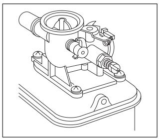
Fig. 240 - CHOKE LEVER POSITION
