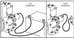
Fig. 662 - TYPICAL STARTER MOTORS
