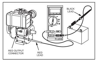
Fig. 776 - TESTING REGULATOR-RECTIFIER
