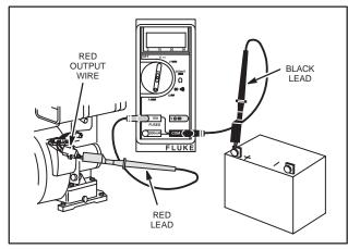
Fig. 772 - TESTING REGULATOR OUTPUT
