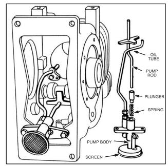
Fig. 562 - MODELS A, B OLD STYLE OIL PUMP
