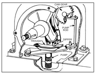
Fig. 563 - MODEL FH OIL PUMP
