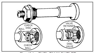
Fig. 124 - FUEL TANK OUTLET
