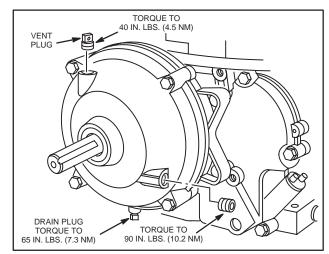
Fig. 143 - FILLING GEAR CASE
