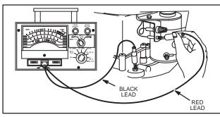
Fig. 764 - TESTING AC OUTPUT
