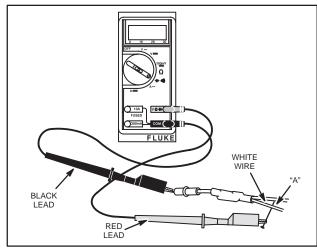
Fig. 770 - DIODE TESTING - LIGHTING CIRCUIT
