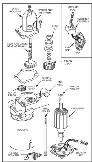
Fig. 664 - 12V & 120V STARTER MOTOR, **EXPLODED VIEW**
