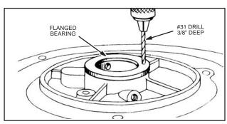
Fig. 906 - PINING FLANGE BEARING
