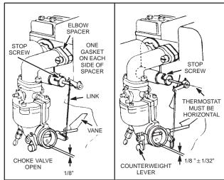
Fig. 314 – ADJUST AUTOMATIC CHOKE
