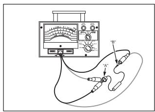
Fig. 752 - TESTING ISOLATION DIODE
