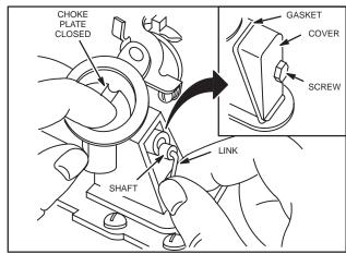
Fig. 244 - INSERTING CHOKE LINK
