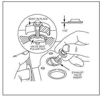
Fig. 523 - INSERTING VALVE SEAT PULLER
