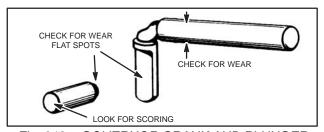
Fig. 319 - GOVERNOR CRANK AND PLUNGER
