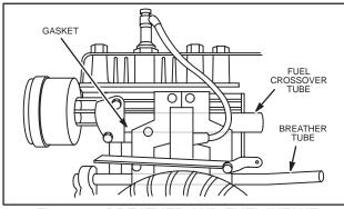
Fig. 215 – BREATHER AND FUEL INTAKE TUBES
