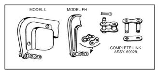
Fig. 586 - STARTER REPAIR LINK
