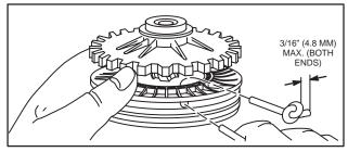
Fig. 629 - STARTING ROPE IN PULLEY
