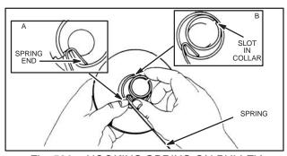
Fig. 590 - HOOKING SPRING ON PULLEY
