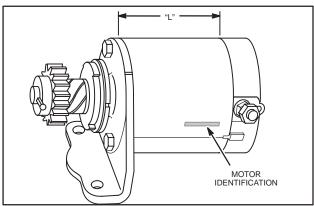
Fig. 689 – TYPICAL 12 VOLT DC STARTER MOTOR
