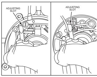
Fig. 56 - ADJUSTING BREAKER POINTS
