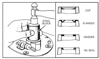
Fig. 911 - BEARING OIL RETAINERS
