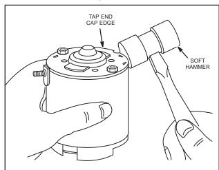
Fig. 675 – ALIGNING BEARINGS
