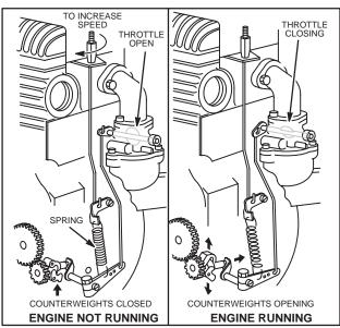
Fig. 315 - MECHANICAL GOVERNOR, TYPICAL
