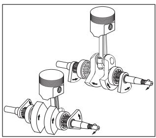
Fig. 182 – CAST IRON ENGINES, COUNTERBALANCE
