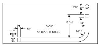
Fig. 350 - TANG BENDING TOOL
