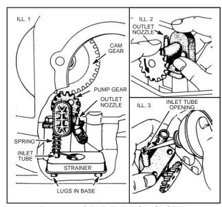
Fig. 571 - GEAR TYPE OIL SYSTEM
