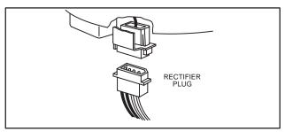
Fig. 748 - RECTIFIER PLUG
