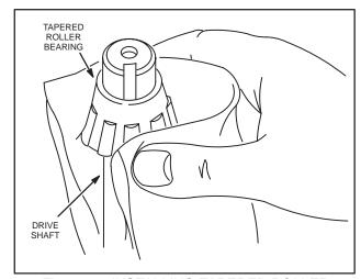
Fig. 146 – INSTALLING TAPERED ROLLER BEARINGS
