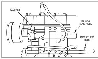
Fig. 145 – BREATHER AND INTAKE MANIFOLD
