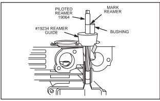
Fig. 518 - REBUSHING
