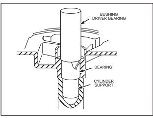
Fig. 927 - PRESSING BEARING
