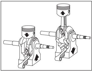
Fig. 188 - OSCILLATING COUNTERBALANCE
