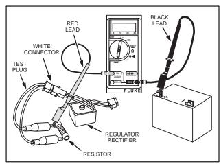
Fig. 774 - TESTING LIGHTING CIRCUIT
