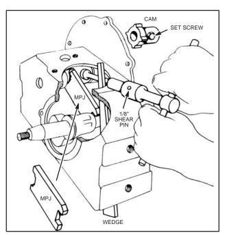
Fig. 883 - ASSEMBLE CAM GEAR, MODEL PB
