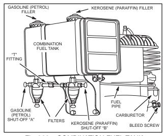
Fig. 298 - COMBINATION FUEL TANK
