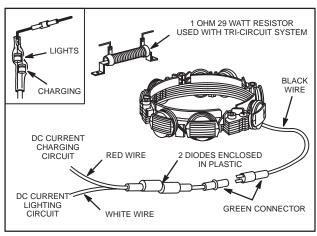
Fig. 767 – TRI-CIRCUIT ALTERNATOR
