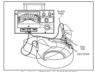
Fig. 763 - TESTING RECTIFIER
