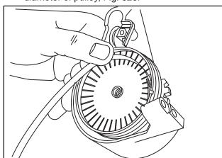
Fig. 626 - INSTALLING SPRING IN OUTER RETAINER
