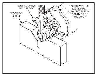
Fig. 691 - DISASSEMBLING STARTER MOTOR DRIVE
