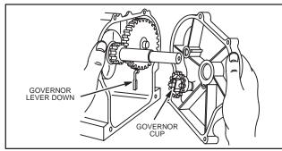
Fig. 339 – SHOWING GOVERNOR CRANK PROPER POSITION
