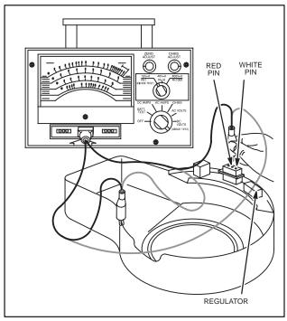
Fig. 756 - TESTING REGULATOR
