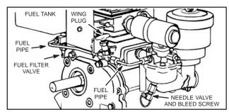
Fig. 295 - KEROSENE FUEL SYSTEM
