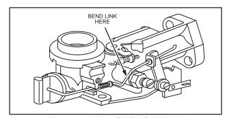
Fig. 202 - ADJUST CHOKE LINK
