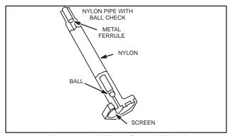
Fig. 182 - FUEL PICK-UP TUBE
