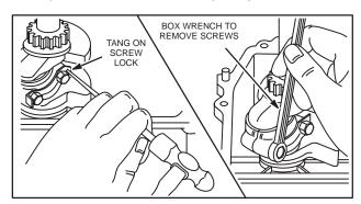
Fig. 538 - BENDING ROD LOCK
