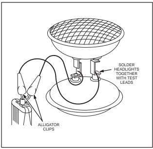
Fig. 649 - BATTERY TESTER
