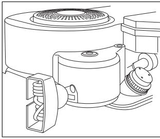
Fig. 616 - ALTERNATE STYLE VERTICAL PULL
