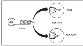
Fig. 233 - MIXTURE NEEDLE
