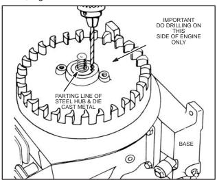
Fig. 115 - REMOVING RUSTED FLYWHEEL
