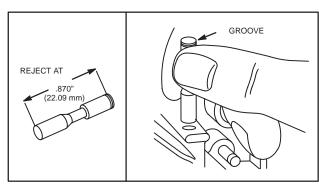
Fig. 54 – CHECKING BREAKER POINT PLUNGER
