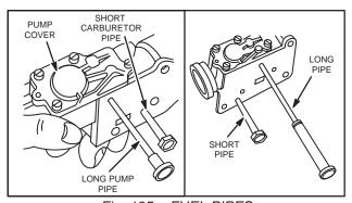
Fig. 195 – FUEL PIPES
