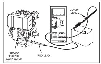
Fig. 782 - TESTING REGULATOR-RECTIFIER
