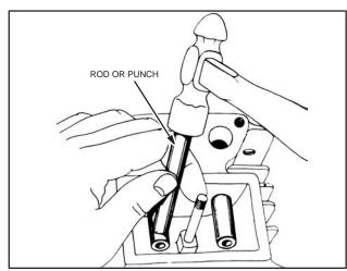
Fig. 528 - BREAKING OFF LOWER HALF
