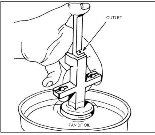
Fig. 560 - EJECTION PUMP
