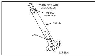
Fig. 153 - FUEL PICK-UP TUBE
