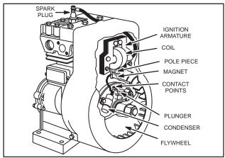
Fig. 77 - BREAKER POINT IGNITION
