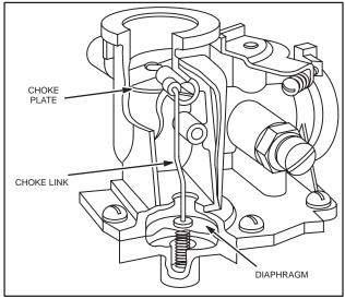
Fig. 219 - AUTOMATIC CHOKE SYSTEM
