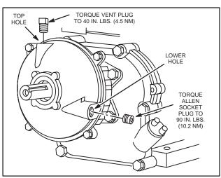
Fig. 136 - FILLING GEAR CASE
