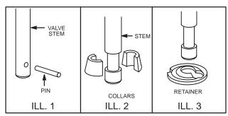
Fig. 509 - VALVE SPRING RETAINERS
