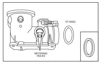
Fig. 208 - METERING HOLES AND "O"-RING
