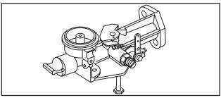
Fig. 175 - VACU-JET CARBURETOR
