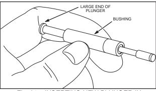
Fig. 61 – INSERTING NEW PLUNGER IN BUSHING
