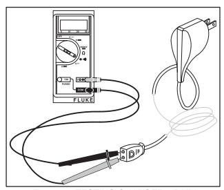
Fig. 651 - TESTING CHARGER - DMM
