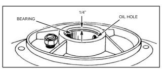
Fig. 904 - ALIGNING BEARING
