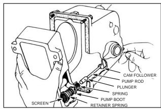
Fig. 566 - OIL SYSTEM MODEL FI
