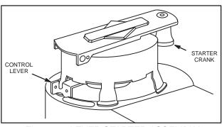
Fig. 636 - LEVER STARTER ASSEMBLY
