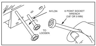
Fig. 151 – REMOVING FUEL PICK-UP TUBES, TYPICAL
