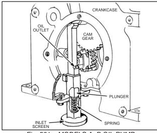
Fig. 561 - MODELS A, B OIL PUMP
