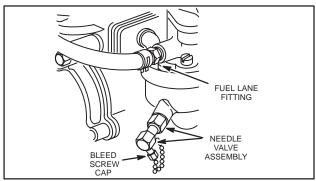
Fig. 299 - COMBINATION FUEL CARBURETOR
