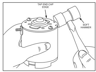
Fig. 661 - ALIGNING END CAP BEARING
