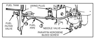
Fig. 296 - KEROSENE FUEL SYSTEM
