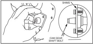
Fig. 886 - INSTALLING CAM GEAR BEARING
