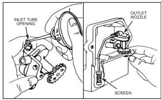
Fig. 572 - HORIZONTAL ENGINE OIL PUMP
