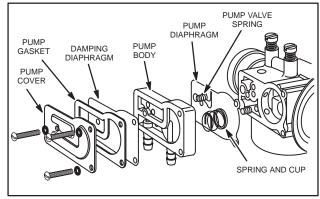
Fig. 291 – ASSEMBLE FUEL PUMP
