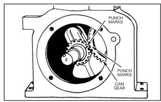
Fig. 531 - VALVE TIMING
