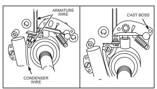
Fig. 33 - ADJUSTING STYLE II BREAKER POINTS
