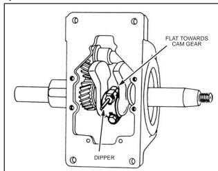
Fig. 574 - POSITION OF OIL DIPPER
