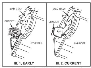
Fig. 577 - OIL SLINGER AND BRACKET
