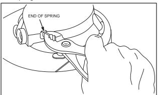
Fig. 600 - REMOVE SPRING
