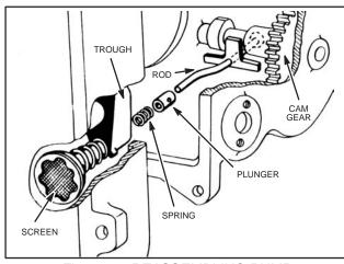
Fig. 567 - REASSEMBLING PUMP
