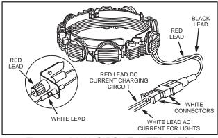
Fig. 765 - DUAL CIRCUIT ALTERNATOR
