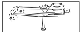
Fig. 128 - VACU-JET CARBURETOR
