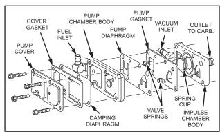
Fig. 313 – EXPLODED VIEW, TYPICAL FUEL PUMP
