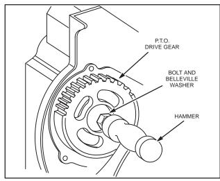
Fig. 871 - REMOVE LONG BOLT
