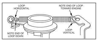
Fig. 330 - CORRECT POSITION OF SPRING
