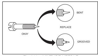
Fig. 209 - MIXTURE NEEDLE
