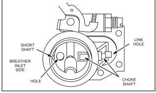
Fig. 158 - ASSEMBLING AUTOMATIC CHOKE
