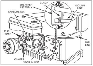
Fig. 308 – PUMP ON CARBURETOR, BREATHER VALVE VACUUM
