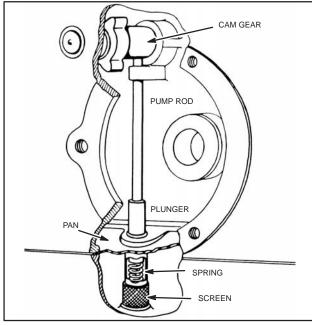
Fig. 573 - MODEL PB OIL SYSTEM
