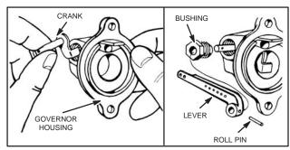
Fig. 324 - INSTALL CRANK AND LEVER
