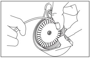
Fig. 627 - WINDING SPRING
