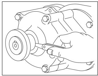
Fig. 151 – CHECKING END PLAY USING PULLEY POCKET
