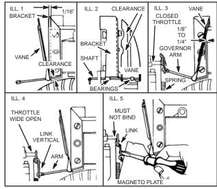
Fig. 318 - ALIGNING GOVERNOR PARTS
