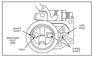
Fig. 239 - ASSEMBLING AUTOMATIC CHOKE
