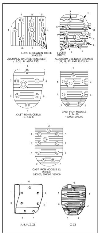
Fig. 493 - TORQUE PATTERN, CYLINDER HEADS
