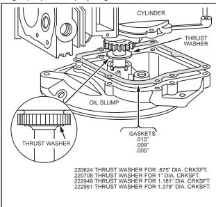
Fig. 897 - ADJUSTING CRANKSHAFT END PLAY
