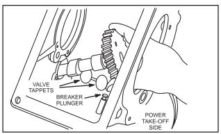
Fig. 884 - INSERTING CAM GEAR
