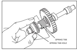
Fig. 162 - INSTALL CLUTCH SLEEVE
