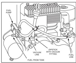
Fig. 309 – PUMP ON BRACKET, DIPSTICK TUBE VACUUM
