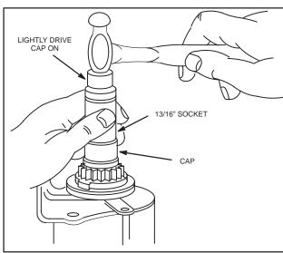
Fig. 695 - INSTALLING PLASTIC CAP
