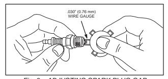
Fig. 3 – ADJUSTING SPARK PLUG GAP
