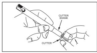
Fig. 520 - INSERTING CUTTER SHANK
