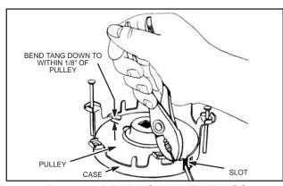
Fig. 592 - BENDING PULLEY TANGS
