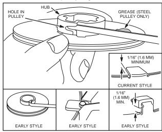
Fig. 601 - INSTALL SPRING
