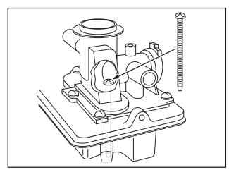
Fig. 224 - SCREW UNDER CHOKE PLATE
