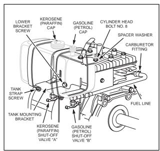
Fig. 297 - COMBINATION FUEL TANK
