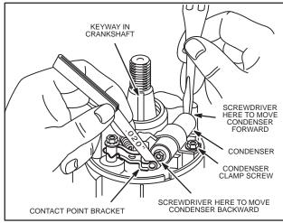
Fig. 96 – ADJUSTING STYLE II BREAKER POINTS
