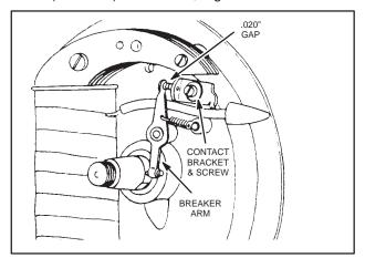
Fig. 25 - ADJUSTING BREAKER POINTS
