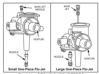
Fig. 260 - REPAIR CARBURETORS
