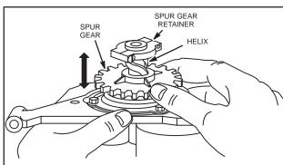
Fig. 653 - STARTER MOTOR DRIVE
