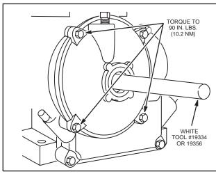
Fig. 135 - INSTALLING GEAR CASE COVER
