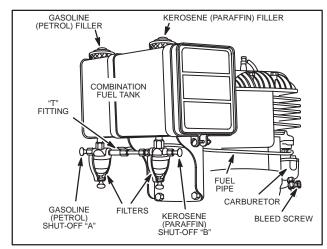
Fig. 294 - COMBINATION FUEL TANK
