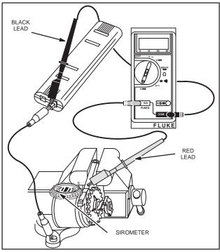
Fig. 654 - TESTING STARTER MOTOR
