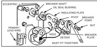
Fig. 45 – ASSEMBLING BREAKER BOX
