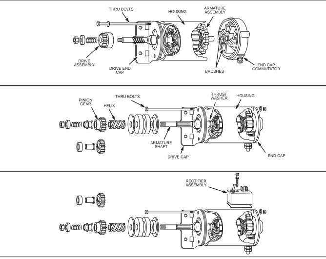
Fig. 676 – STARTER MOTORS (EXPLODED VIEWS)
