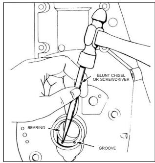
Fig. 907 - STAKING BEARING
