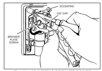
Fig. 47 – ADJUSTING BREAKER POINTS
