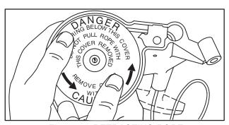
Fig. 632 - RETRACTING ROPE
