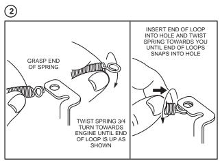
Fig. 334 – ASSEMBLE SPRING TO CONTROL LEVER
