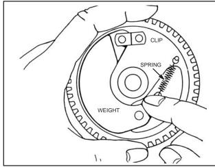
Fig. 877 – CHECKING AUTOMATIC SPARK ADVANCE
