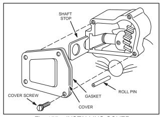
Fig. 155 - INSTALLING COVER
