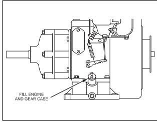
Fig. 152 - FILLING GEAR CASE
