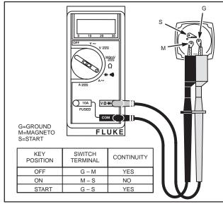
Fig. 652 - TESTING KEY SWITCH
